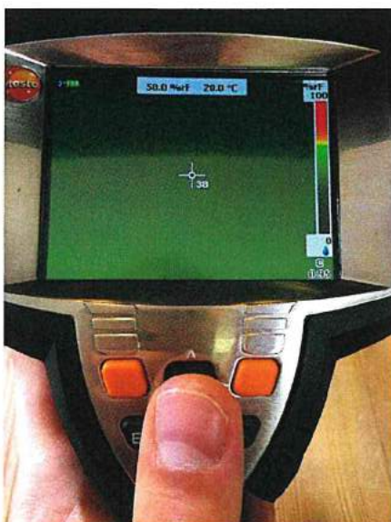
Abb. 39 - Ansicht Feuchtemessung (Foto: Paul Kreckel, 2021)
