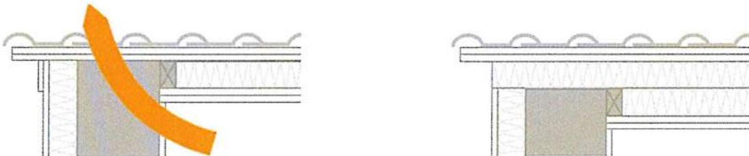
Abb. 67 - Sanierung Wärmebrücke Außenwand und Dach (DENA-Leitfaden, Dezember 2015)
