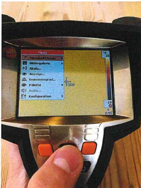
Abb. 37 - Feuchtemessfunktion (Foto: Paul Kreckel, 2021)
